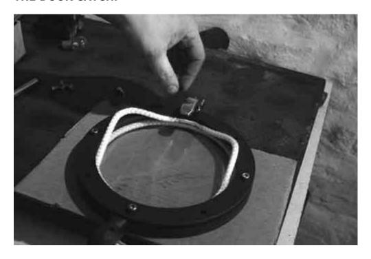
8: THEN WITH YOUR FINGER TIPS CAREFULLY PROCEED TO PUSH THE ROPE BETWEEN THE GLASS AND THE DOOR FRONT ALL THE WAY ROUND.
